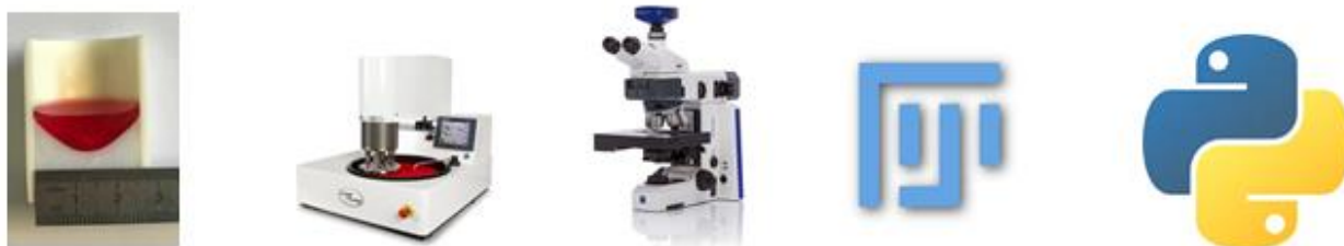
Figure 1: Schéma de la procédure post-mortem utilisée dans le cadre de cette thèse. De gauche à droite : creuset élaboré, préparation d'échantillon, microscope optique, traitement d'image et ensuite traitement de données par Python
